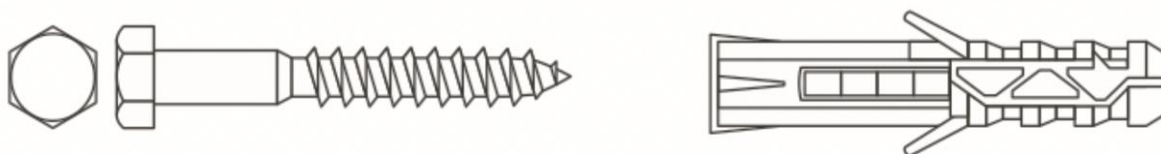
Рисунок 7.4.1 - Шуруп с шестигранной головкой «Глухарь» с дюбелем
