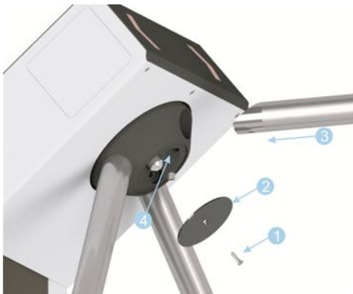
Рисунок 7.5.1 - Установка преграждающей планки
