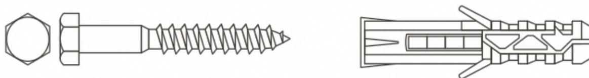
Рисунок 7.4.1 - Шуруп с шестигранной головкой «Глухарь» с дюбелем
