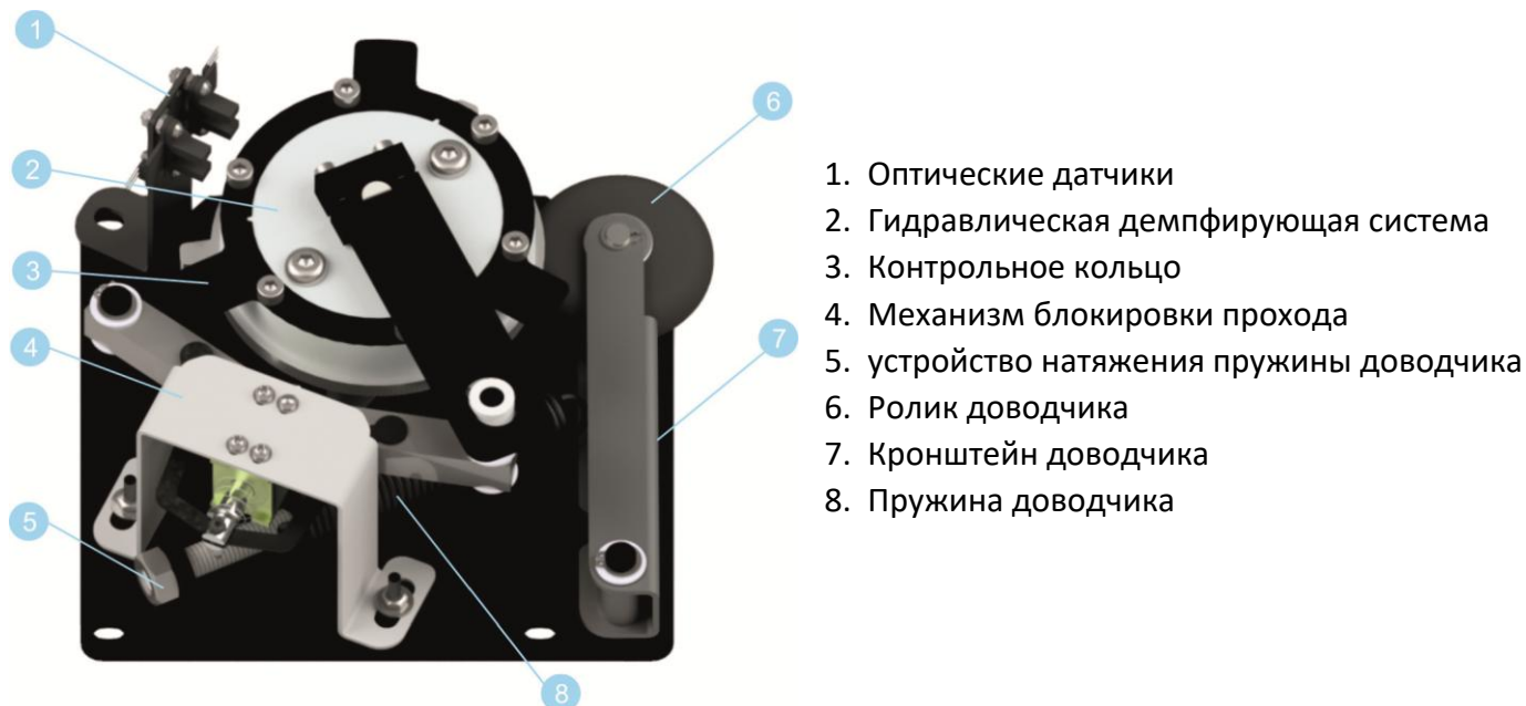
Рисунок 6.2.1. - устройство механизма турникета.
