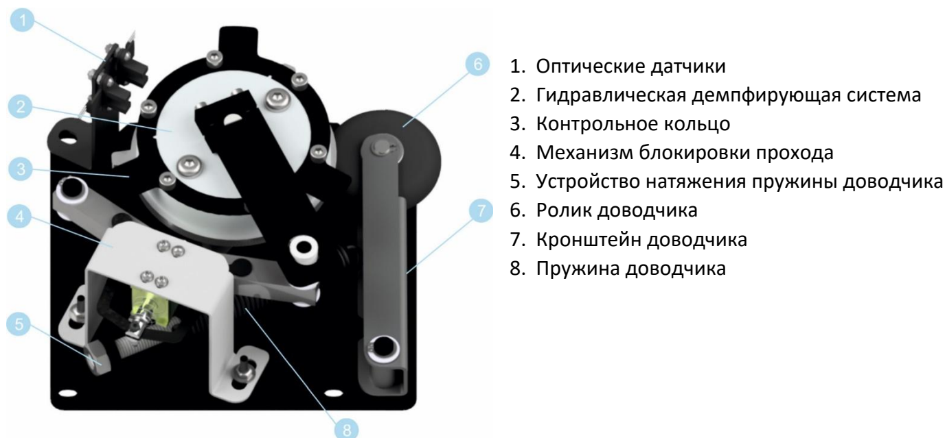
Рисунок 6.2.1. - Устройство механизма турникета
