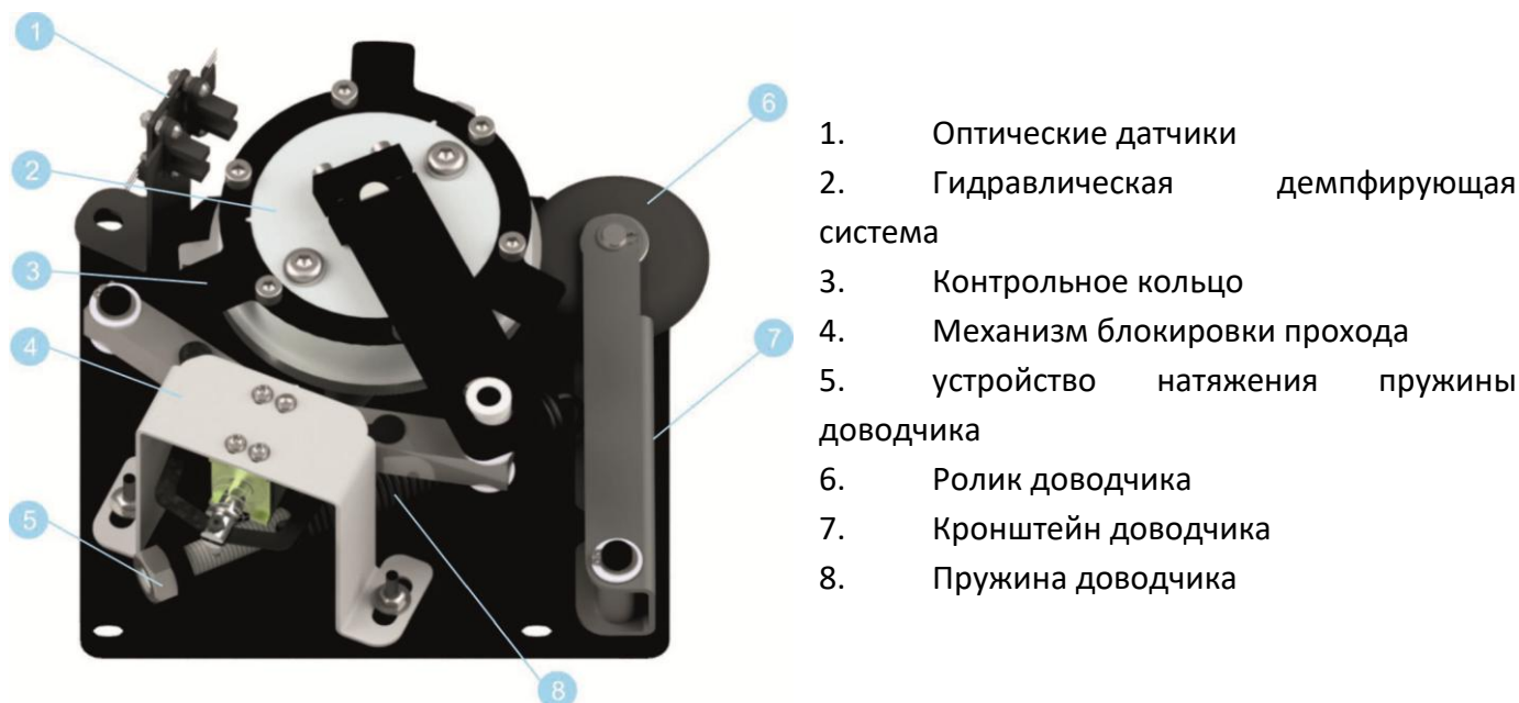
Рисунок 6.2.1. - устройство механизма турникета.
