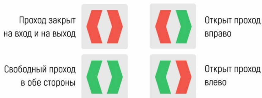
Рисунок 6.4.2 - Режимы индикации турникета
