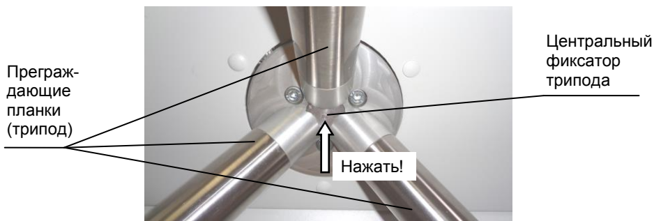
Рис.3 Место расположения центрального фиксатора трипода
