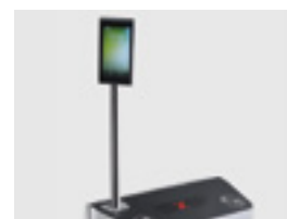
Установка терминала распознавания лиц на турникет
