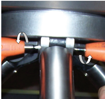
3. Затяните винты (шестигранник 5 мм)
