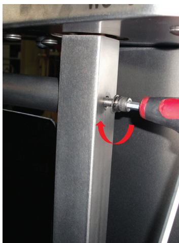
2. Затяните верхний винт
