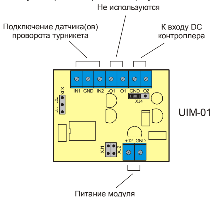
Рисунок 1. Плата модуля сопряжения UIM-01.
