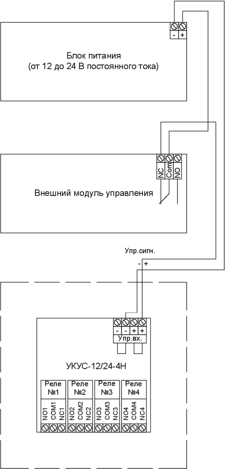
Схема подключения УК-УС к внешнему управляющему модулю с релейным выходом
