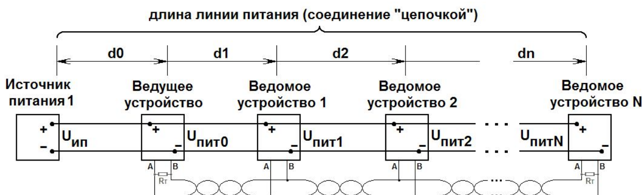
Рис.1. Подключение проводов питания к устройствам сети RS-485 цепочкой.
