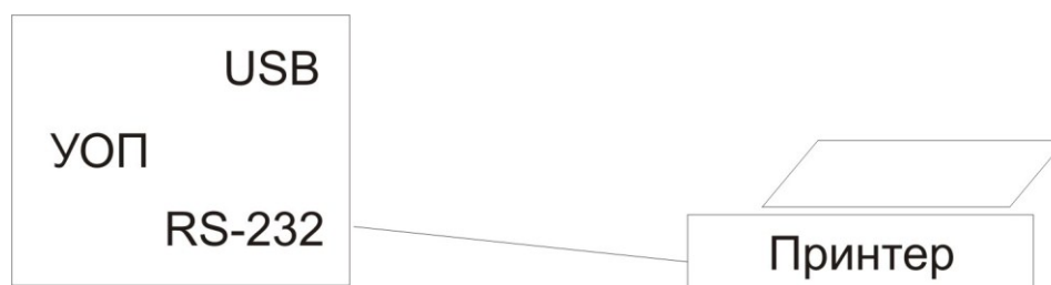
Рисунок А.3 Схема подключения устройства в автономном режиме (только принтер)
