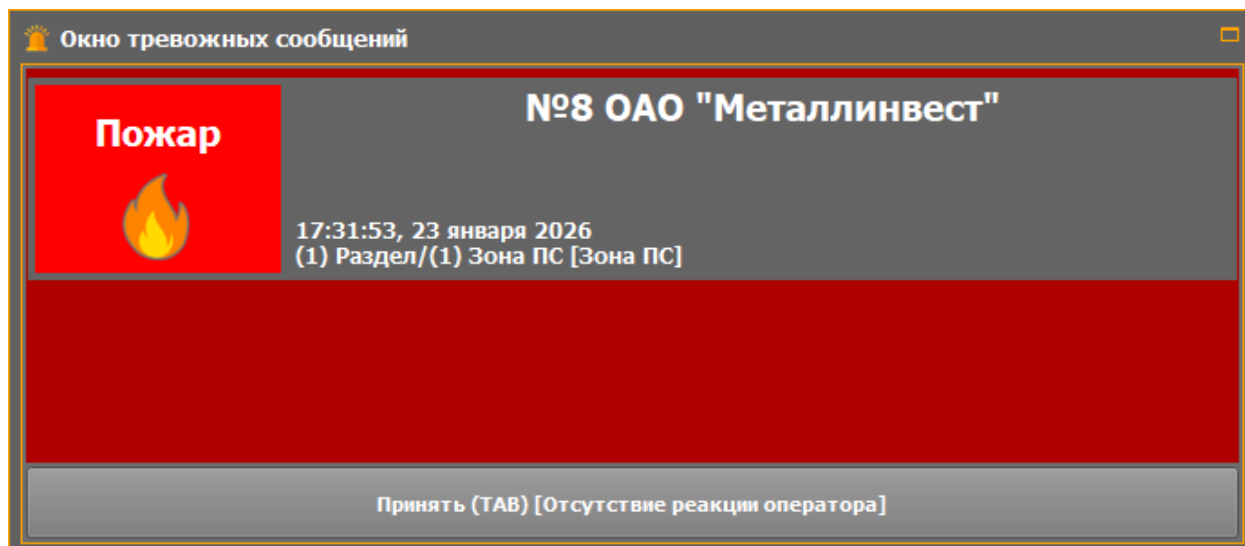
Рисунок 80 Отсутствие реакции оператора на окно тревожных сообщений
