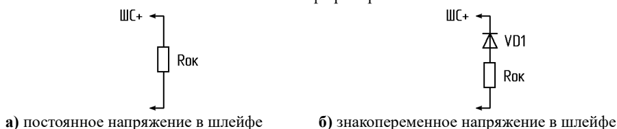
Рисунок 8. Оконечный элемент контроля шлейфа ППКиУП.
