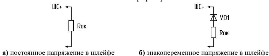
Рисунок 8. Оконечный элемент контроля шлейфа ППКиУП.
