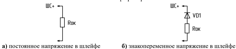
Рисунок 8. Оконечный элемент контроля шлейфа ППКиУП.
