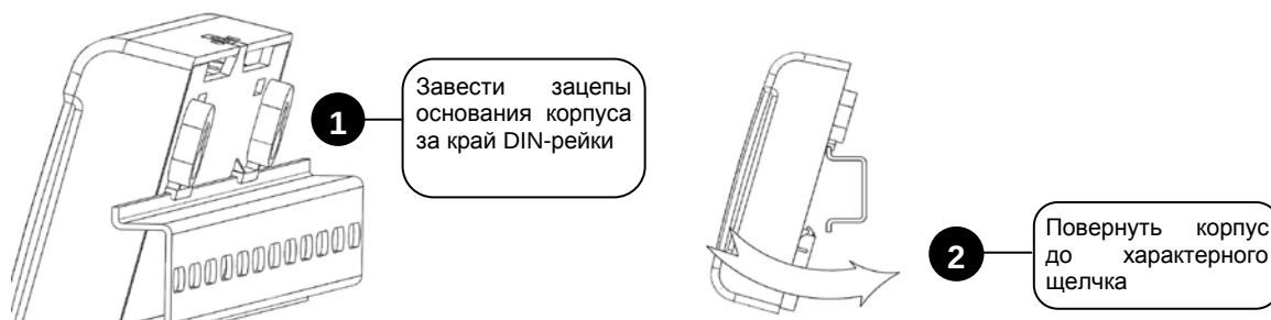
Рисунок 17. Монтаж устройства на DIN-рейку
