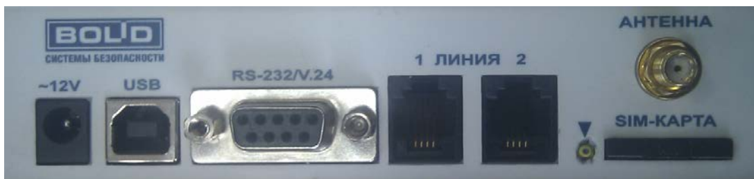
Рисунок 1. Задняя крышка «УОП-3 GSM» с разъёмами
