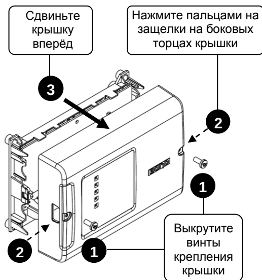
Рисунок 2. Снятие крышки «УО-4С исп.02»
