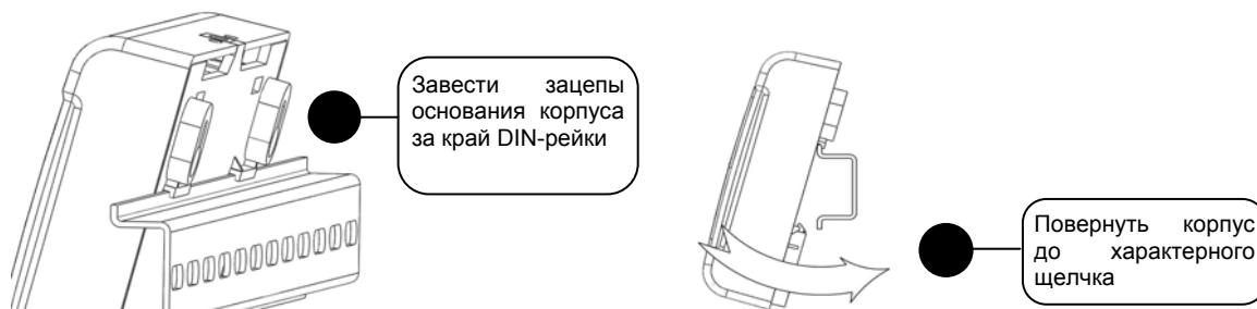
Рисунок 4. Монтаж контроллера на DIN-рейку
