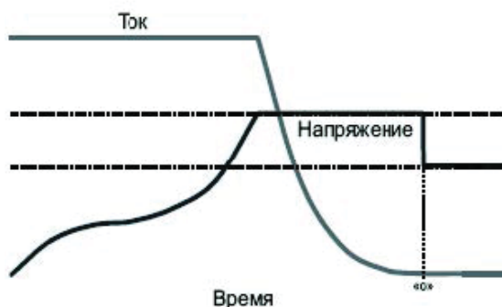
Рис. 6 Зависимость тока и напряжения от времени при заряде по методу IUoU.
