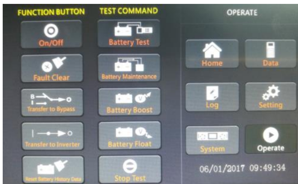
Рисунок 5.3 Тестирование батарейного массива Battery maintenance
