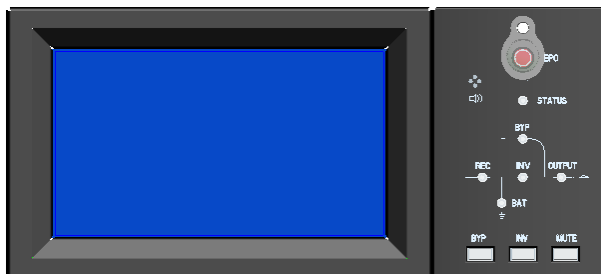
Рисунок 4-1(а) Панель управления для 3 и 6 модульного ИБП
