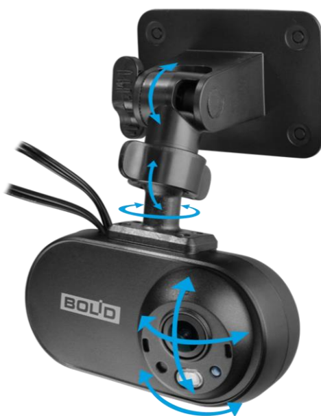
Рисунок 5.3 – Настройка направления объектива
