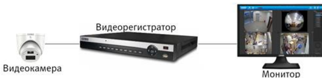
Рисунок 6.2 – Схема подключения видеокамеры
