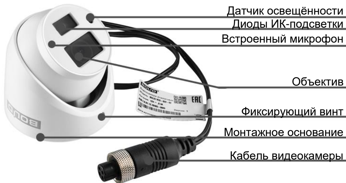
Рисунок 4.1 – Внешний вид и основные элементы видеокамеры
