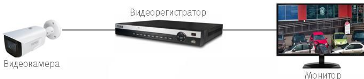
Рисунок 6.2 – Схема подключения видеокамеры
