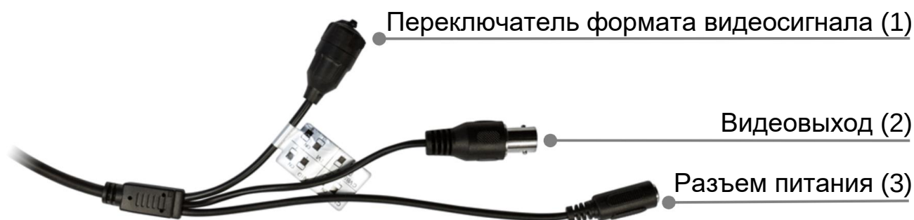
Рисунок 6.1 – Концевая раскладка кабеля видеокamеры
