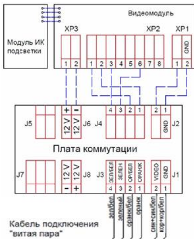
Рисунок 4.6 – Схема подключения камеры с питанием по PoE
