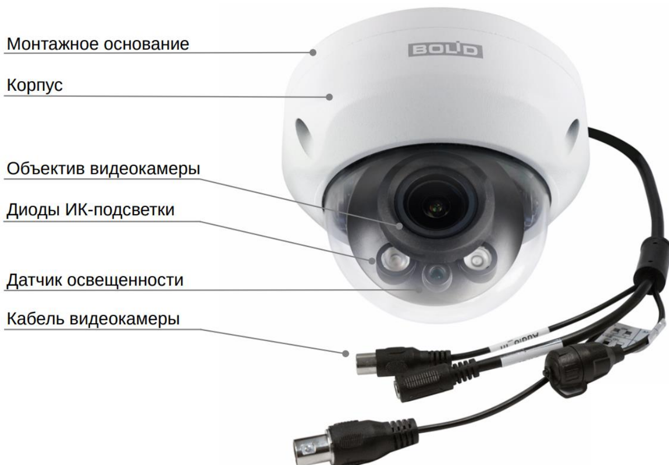
Рисунок 4.1 – Внешний вид и основные элементы видеокамеры
