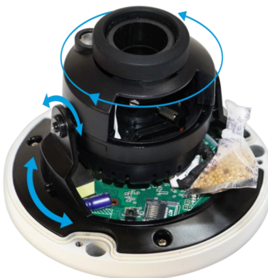
Рисунок 6.5 – Настройка направления объектива
