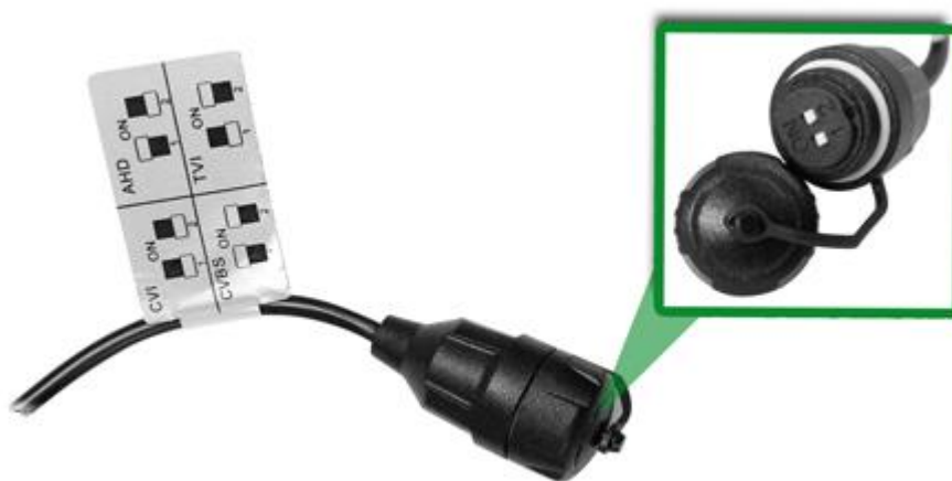
Рисунок 6.3 – Переключатель формата видеосигнала
