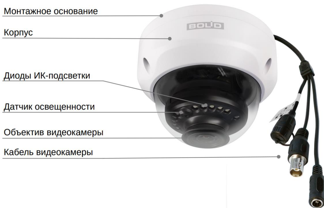
Рисунок 4.1 – Внешний вид и основные элементы видеокамеры
