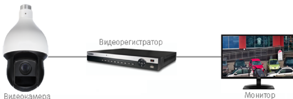
Рисунок 6.2 – Схема подключения видеокамеры
