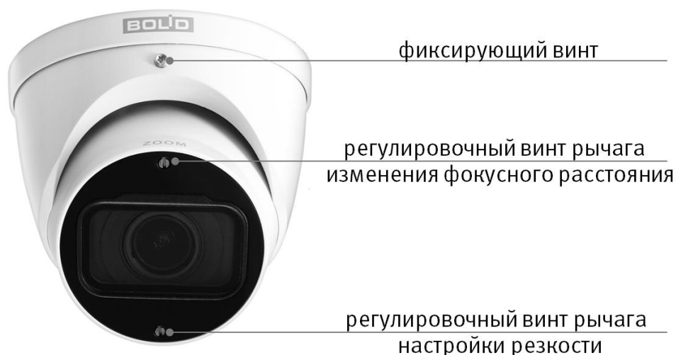
Рисунок 6.4 – Настройка фокусного расстояния и направления объектива
