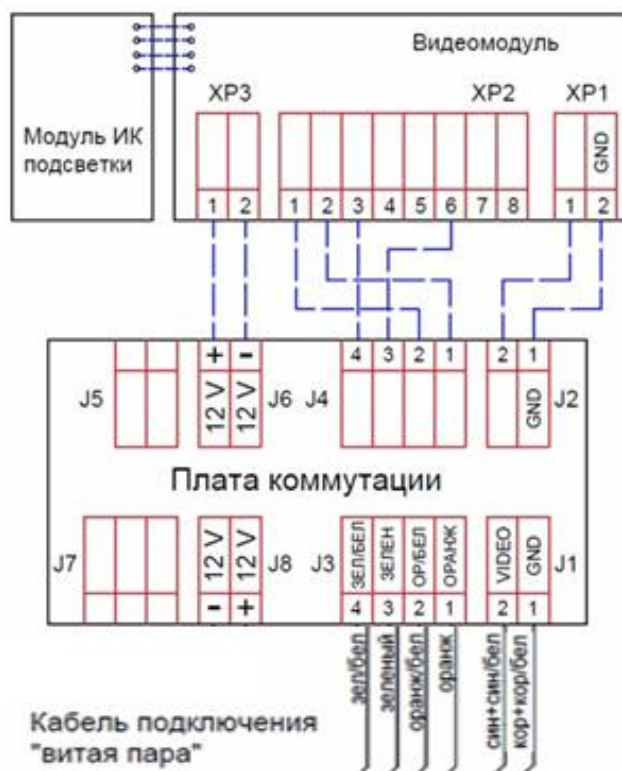
Рисунок 4.6 – Схема подключения камеры с питанием по PoE
