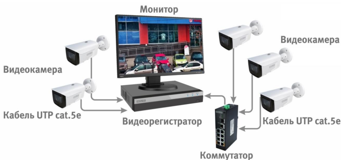
Рисунок 6.4 – Схема подключения видеокамеры к видеорегистратору
