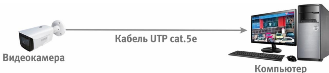
Рисунок 6.2 – Схема подключения видеокамеры к компьютеру
