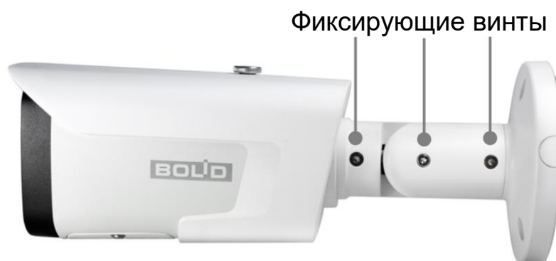
Рисунок 5.14 – Настройка направления объектива
