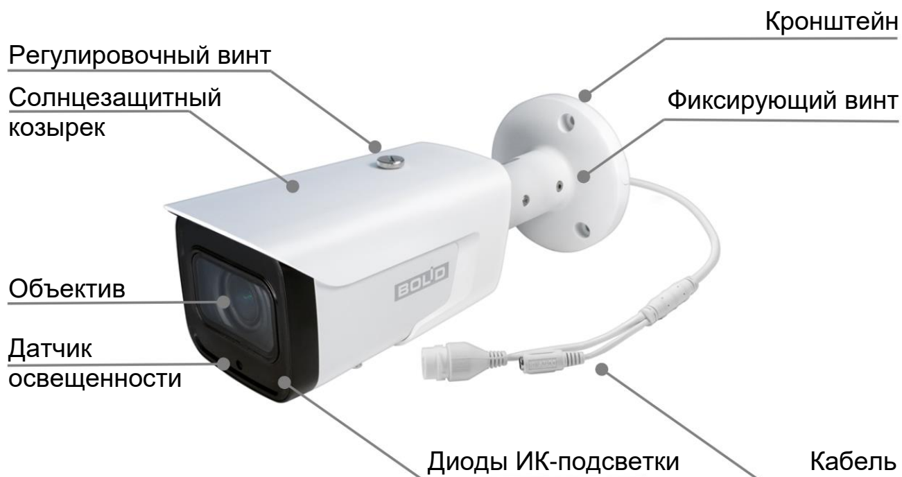
Рисунок 4.1 – Внешний вид и основные элементы видеокамеры
