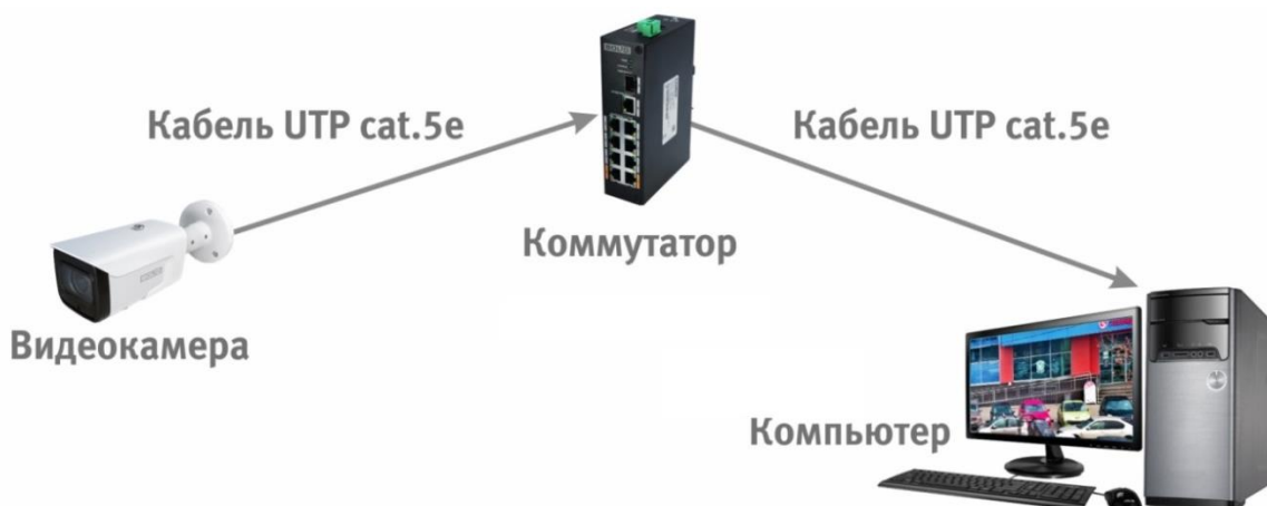
Рисунок 6.3 – Схема подключения видеокамеры к компьютеру через коммутатор
