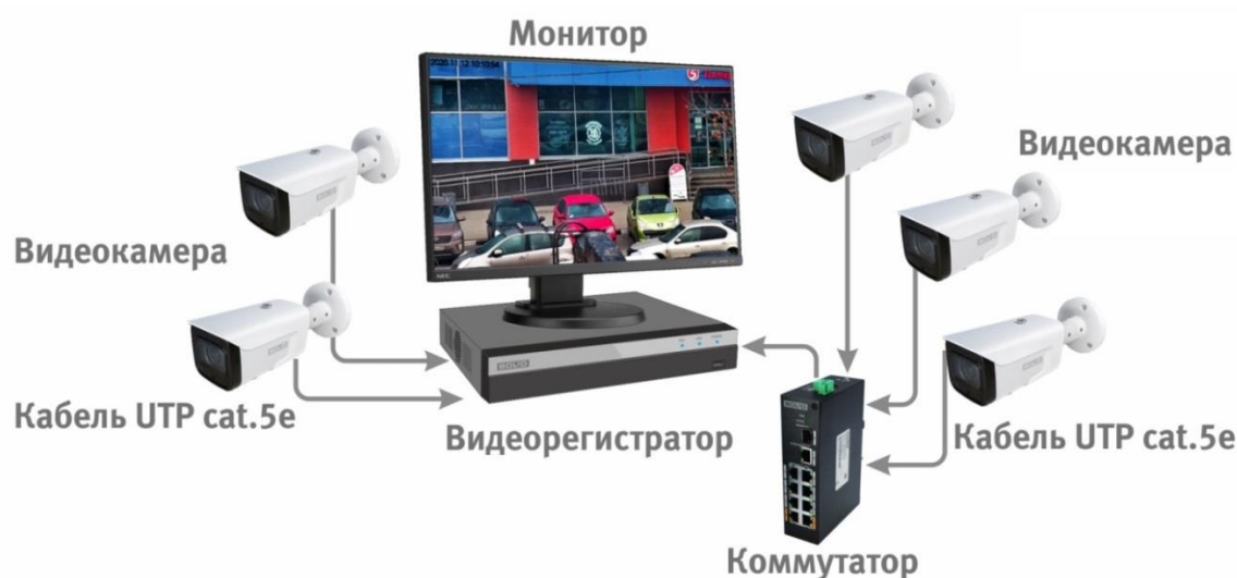
Рисунок 6.4 – Схема подключения видеокамеры к видеорегистратору
