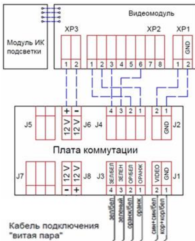
Рисунок 4.6 – Схема подключения камеры с питанием по PoE
