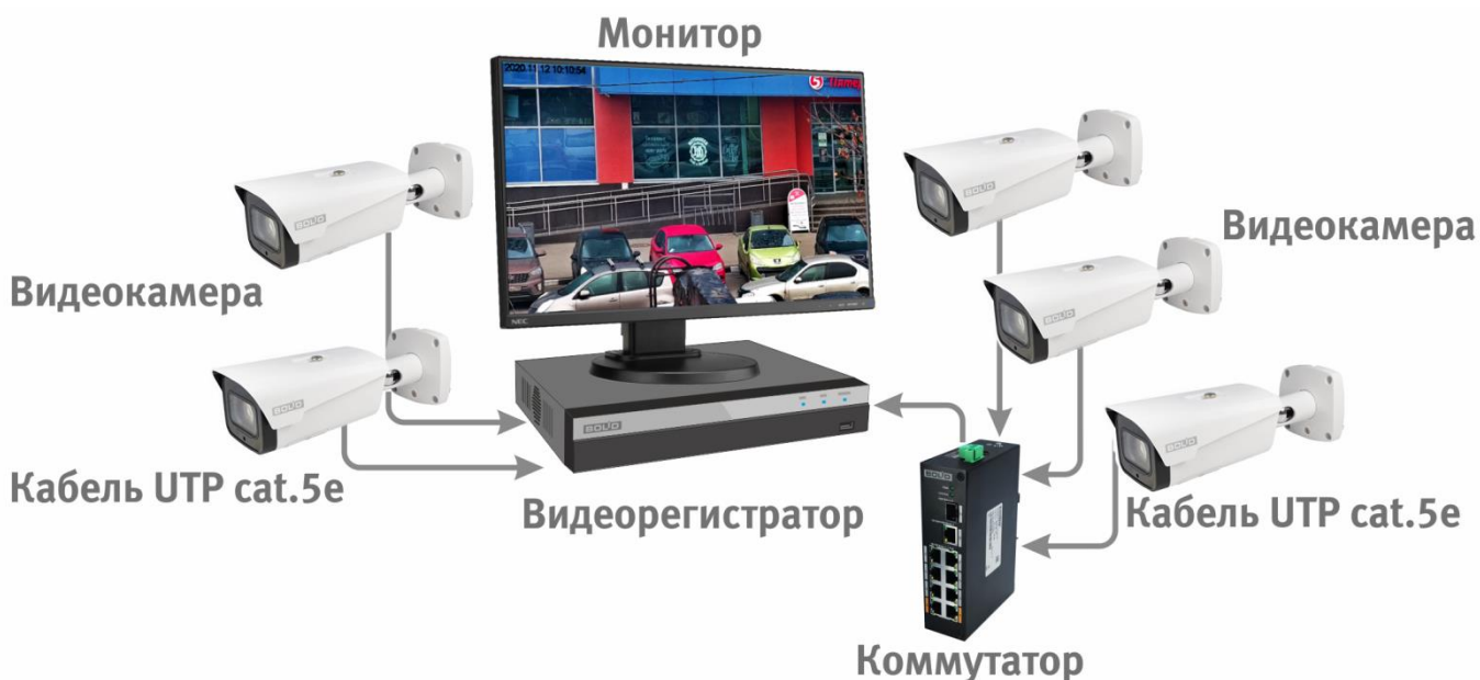
Рисунок 6.5 – Схема подключения видеокамеры к видеорегистратору
