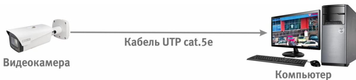
Рисунок 6.3 – Схема подключения видеокамеры к компьютеру
