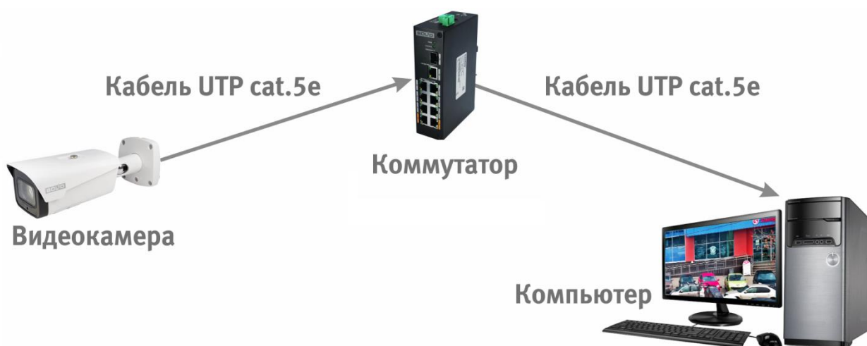
Рисунок 6.4 – Схема подключения видеокамеры к компьютеру через коммутатор
