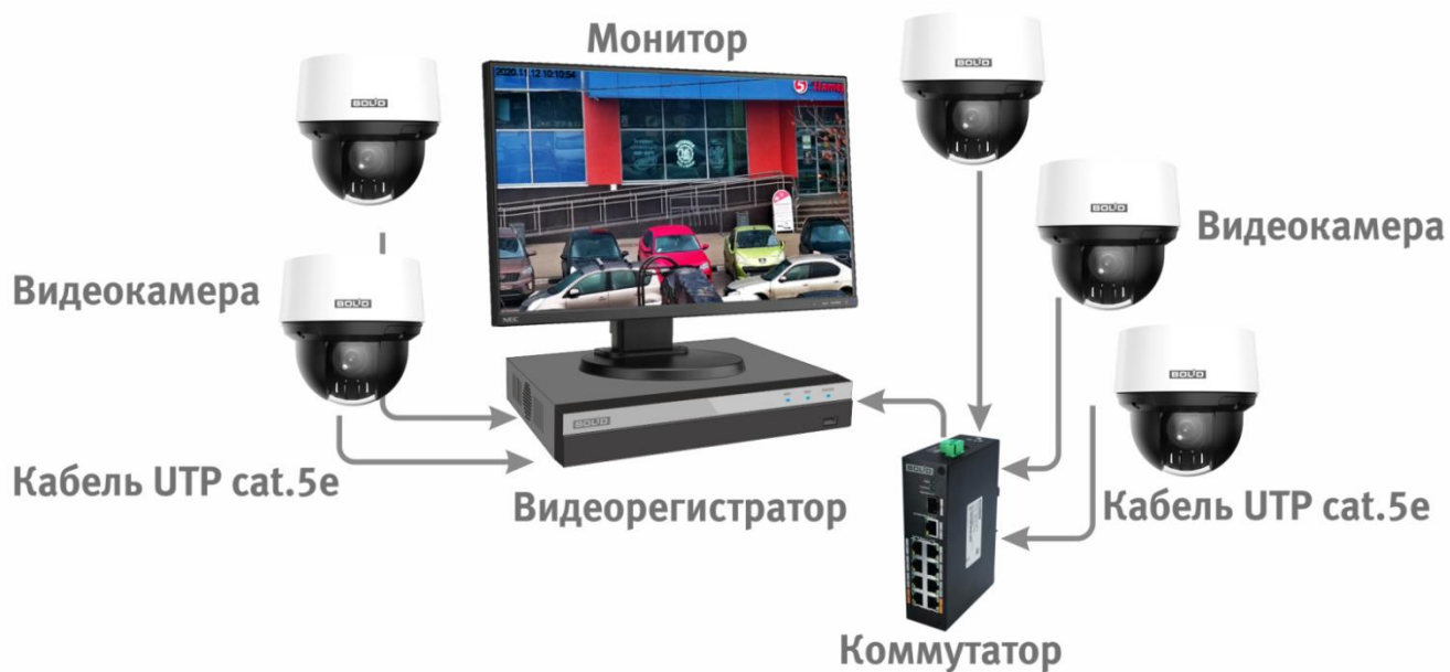
Рисунок 6.4 – Схема подключения видеокамеры к видеорегистратору
