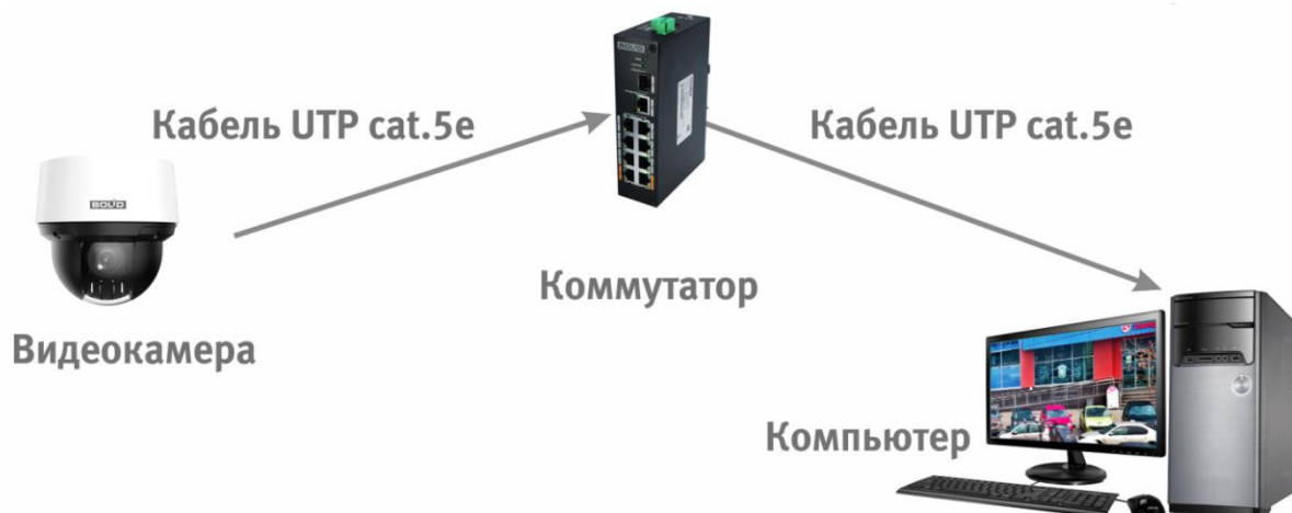
Рисунок 6.3 – Схема подключения видеокамеры к компьютеру через коммутатор
