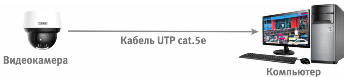
Рисунок 6.2 – Схема подключения видеокамеры к компьютеру
