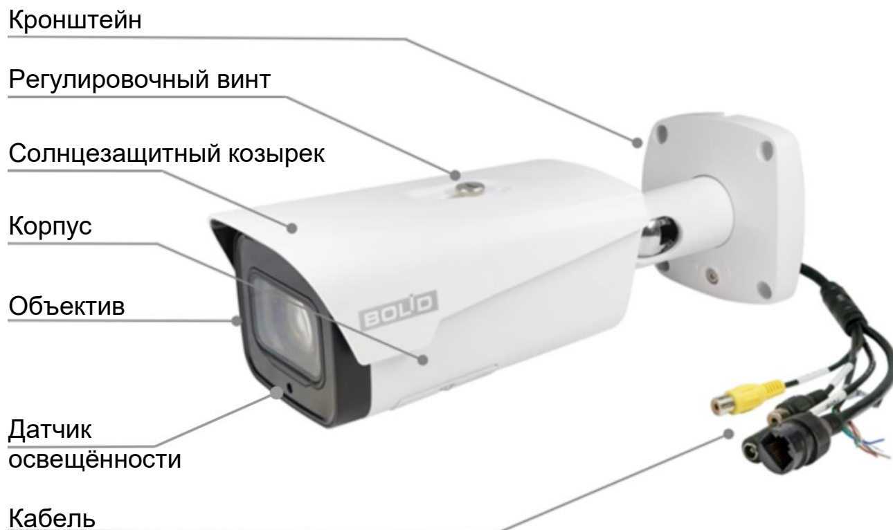
Рисунок 4.1 – Внешний вид и основные элементы видеокамеры
