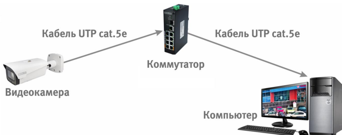
Рисунок 6.4 – Схема подключения видеокамеры к компьютеру через коммутатор
