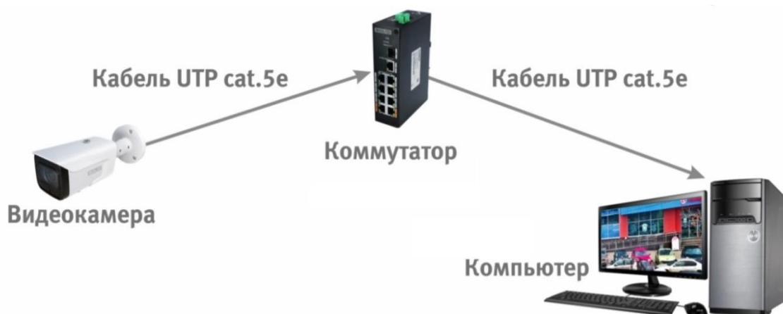
Рисунок 6.3 – Схема подключения видеокамеры к компьютеру через коммутатор
