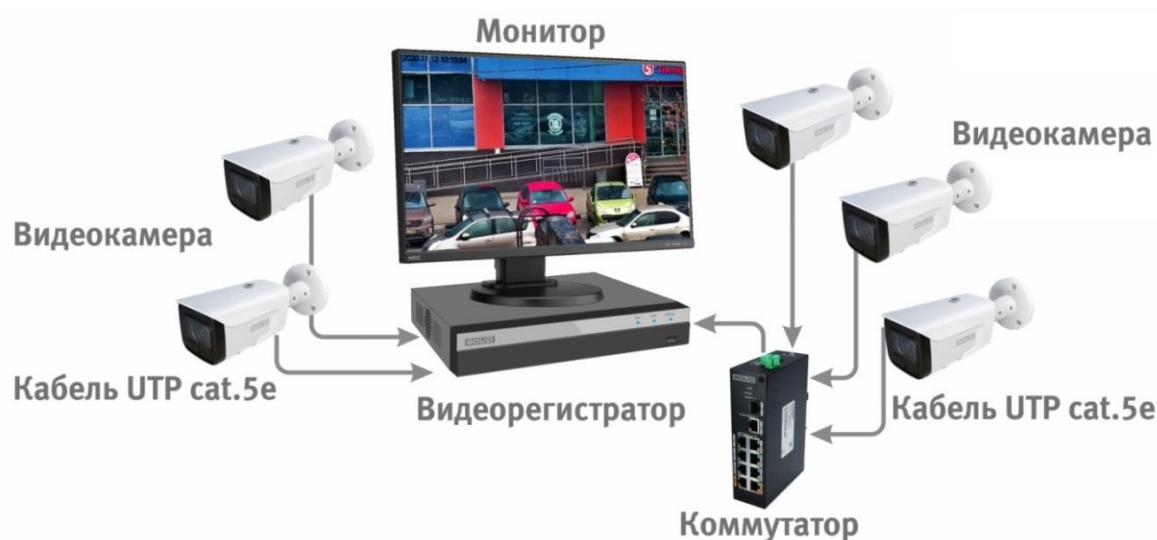
Рисунок 6.4 – Схема подключения видеокamеры к видеорегистратору
