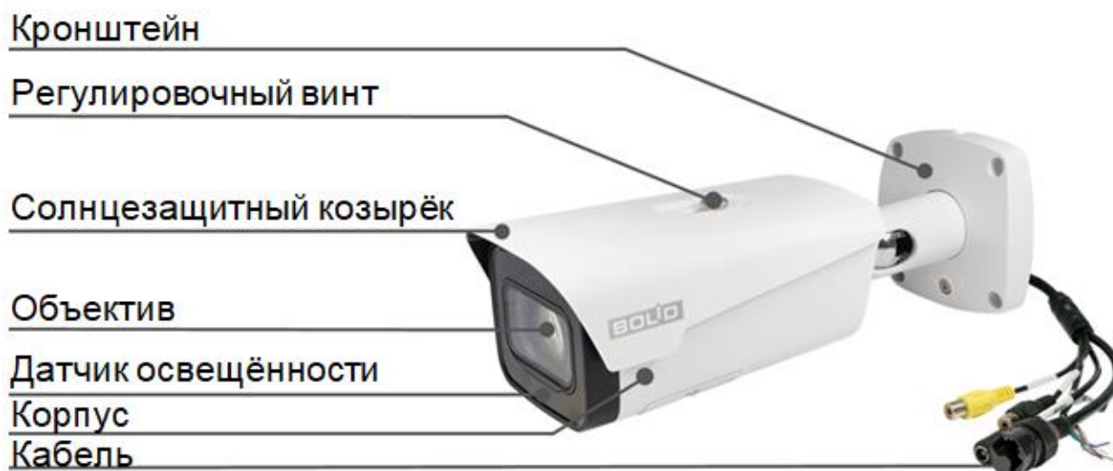
Рисунок 4.1 – Внешний вид и основные элементы видеокамеры
