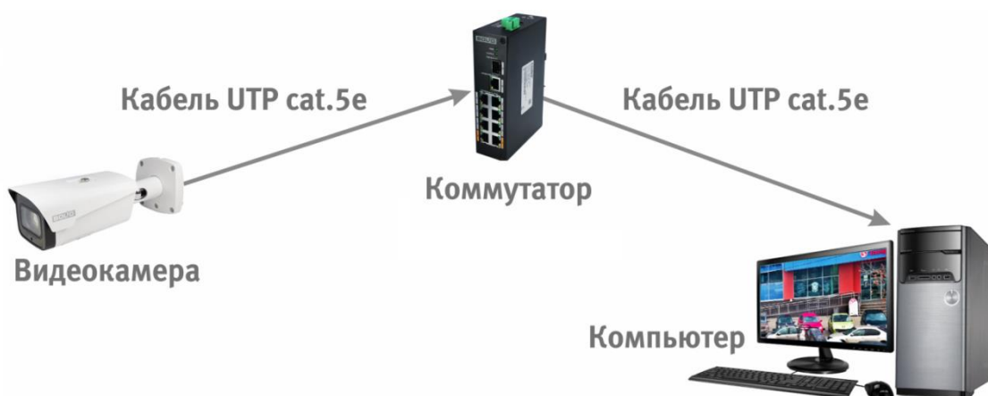
Рисунок 6.3 – Схема подключения видеокамеры к компьютеру через коммутатор
