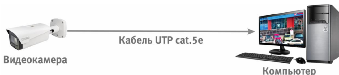
Рисунок 6.2 – Схема подключения видеокамеры к компьютеру
