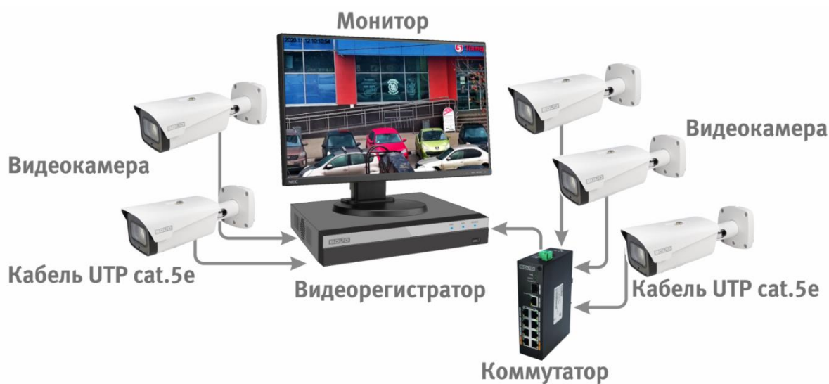
Рисунок 6.4 – Схема подключения видеокамеры к видеорегистратору
