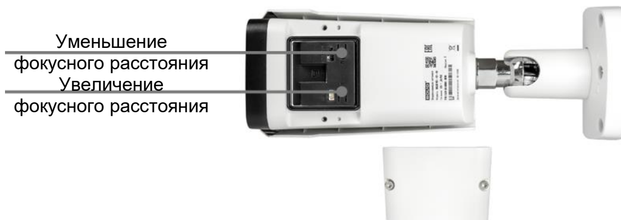
Рисунок 5.14 – Настройка фокусного расстояния вручную
