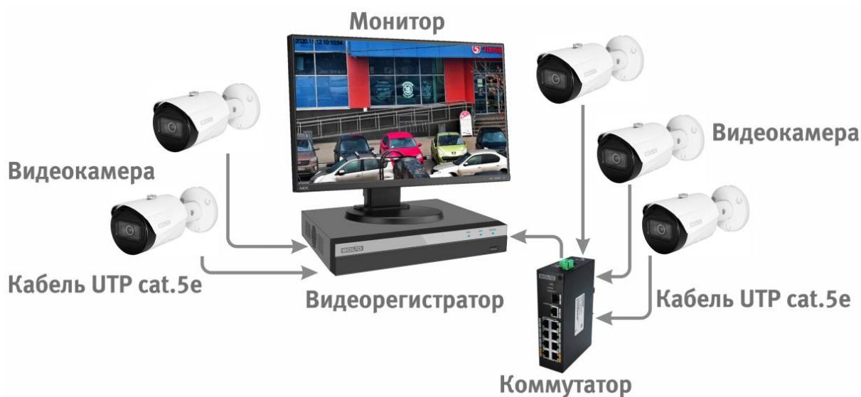
Рисунок 6.4 – Схема подключения видеокamеры к видеорегистратору
