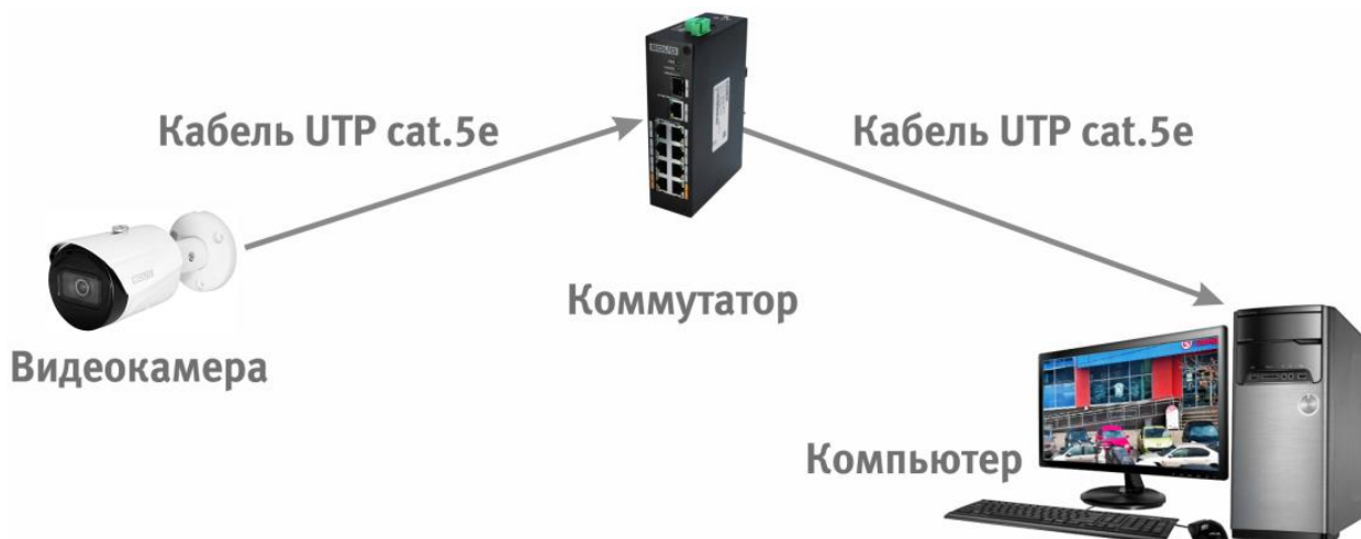
Рисунок 6.3 – Схема подключения видеокамеры к компьютеру через коммутатор
