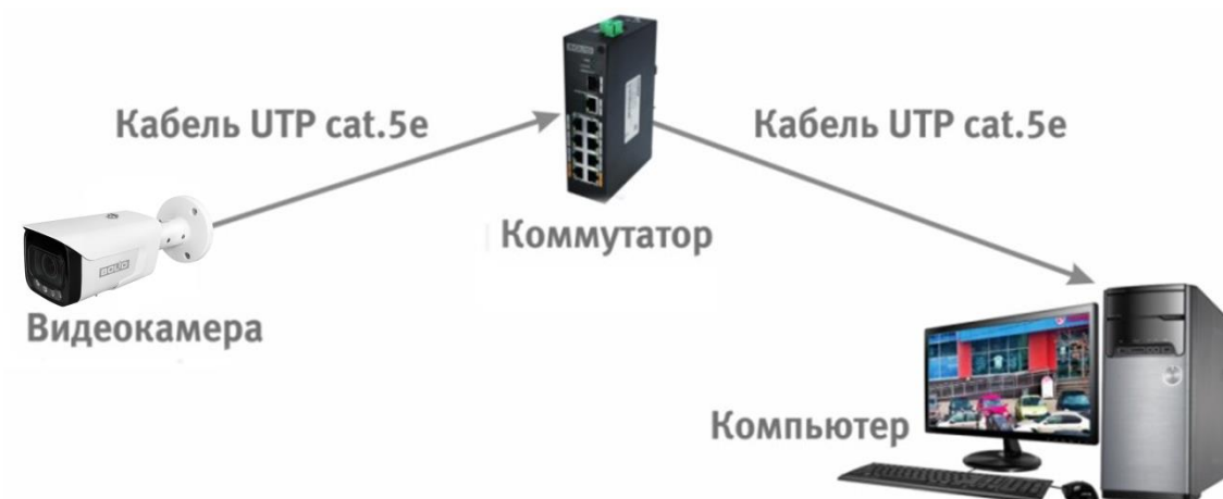
Рисунок 6.3 – Схема подключения видеокамеры к компьютеру через коммутатор
