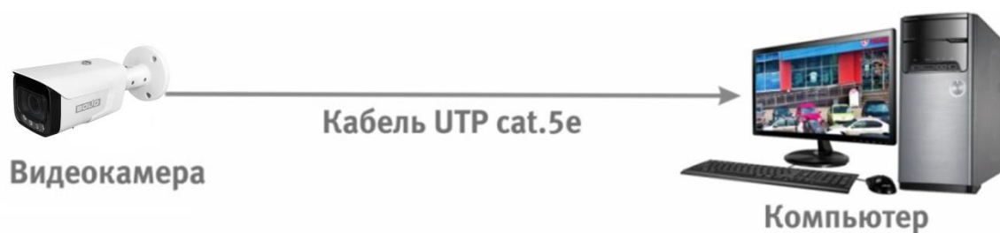
Рисунок 6.2 – Схема подключения видеокамеры к компьютеру
