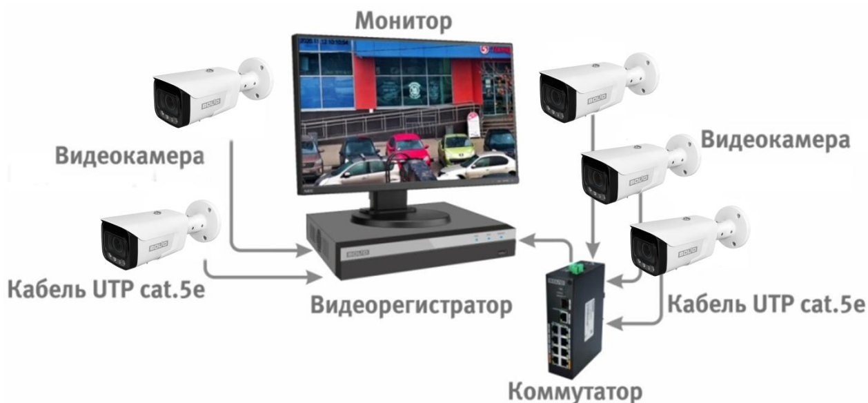
Рисунок 6.4 – Схема подключения видеокамеры к видеорегистратору
