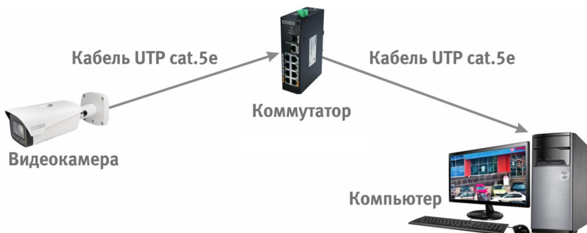
Рисунок 6.3 – Схема подключения видеокамеры к компьютеру через коммутатор
