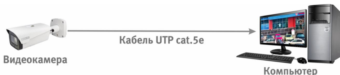
Рисунок 6.2 – Схема подключения видеокамеры к компьютеру
