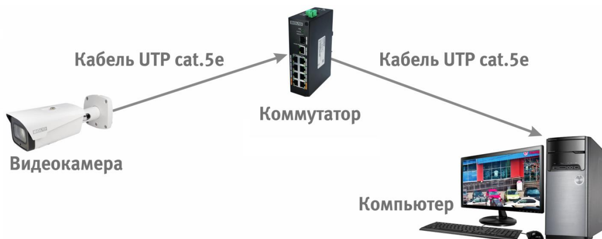
Рисунок 6.4 – Схема подключения видеокамеры к компьютеру через коммутатор
