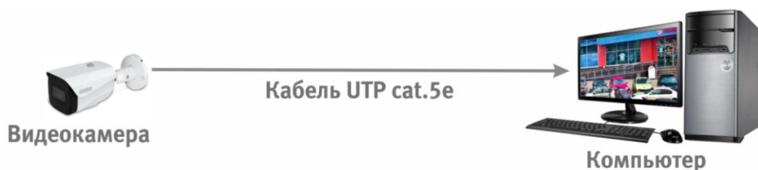
Рисунок 6.2 – Схема подключения видеокамеры к компьютеру
