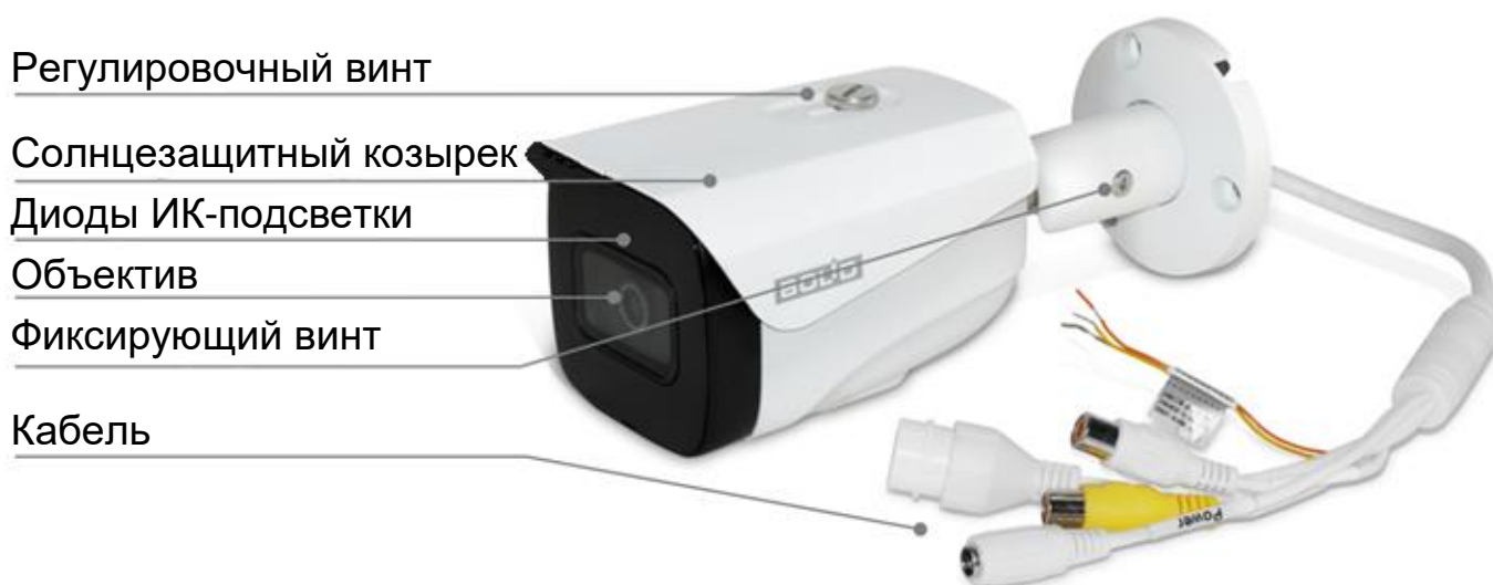
Рисунок 4.1 – Внешний вид и основные элементы видеокамеры
