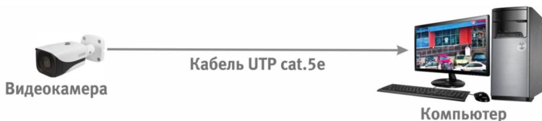
Рисунок 6.2 – Схема подключения видеокамеры к компьютеру
