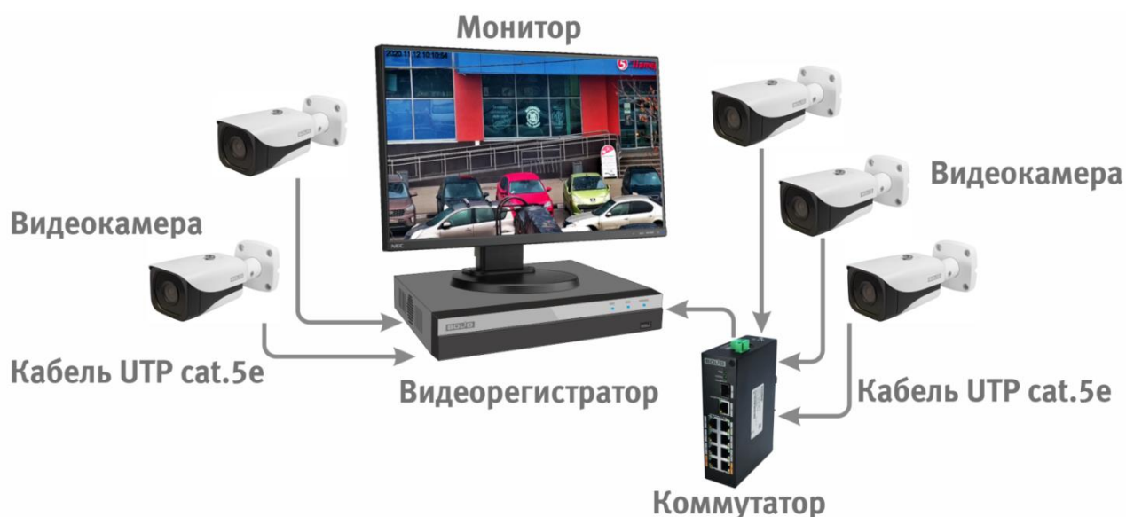
Рисунок 6.4 – Схема подключения видеокamеры к видеорегистратору
