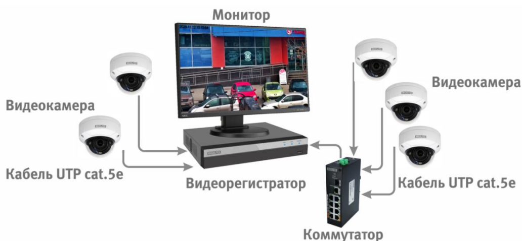
Рисунок 6.4 – Схема подключения видеокамеры к видеорегистратору
