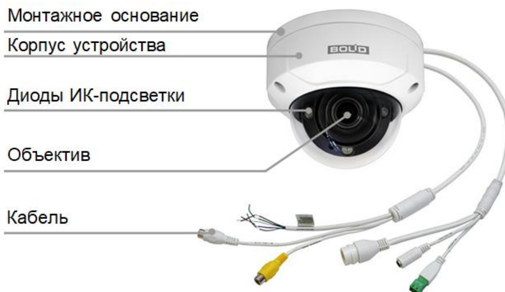
Рисунок 4.1 – Внешний вид и основные элементы видеокамеры
