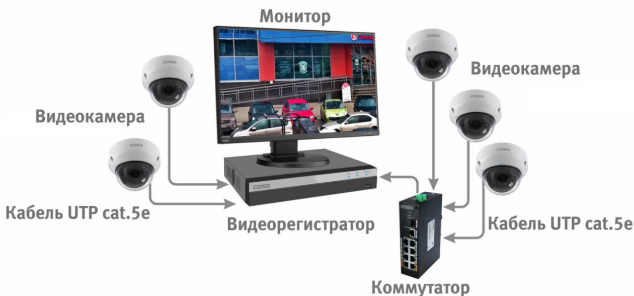
Рисунок 6.4 – Схема подключения видеокamеры к видеорегистратору
